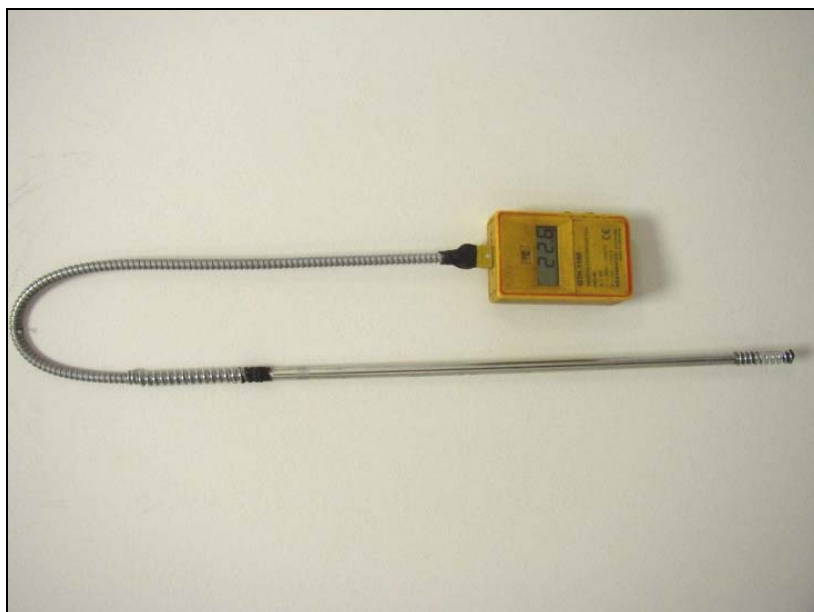
Obrázek 29 Monitorovací jednotka podpovrchových teplot T1p
