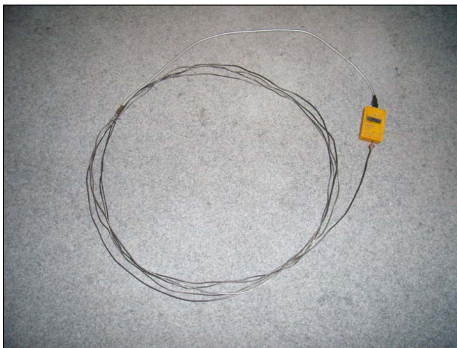
Obrázek 6 Teploměr s pancéřovou hadicí pro měření vysokých teplot
